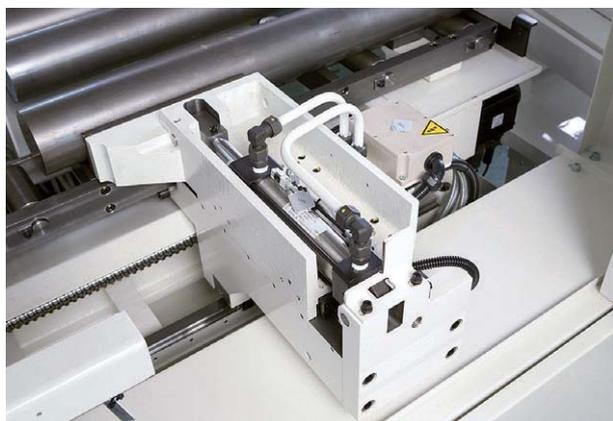
▲ 材料送り込み装置は、直動ベアリングスライド方式、サーボモータ・ボールネジ駆動を採用し高速かつ高精度な定寸送りが可能です。
