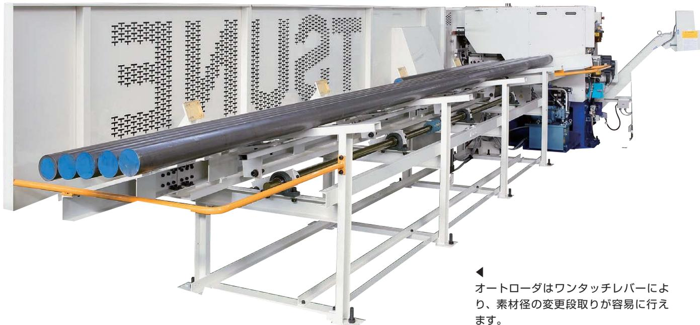
◀ オートローダはワンタッチレバーにより、素材径の変更段取りが容易に行えます。
