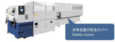
機械本体、オートローダの安全カバーを設置し、高い安全基準に準拠します。
