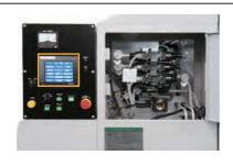
操作盤と同一面に配置された油圧バルブ、津根独自のユーザインターフェイスにより、快適で円滑な操作を提供します。
