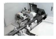
送り台 (GFC) 高速化により、アイドルタイムを短縮します。 Faster GFC motion reduces cycle time, and increases productivity
