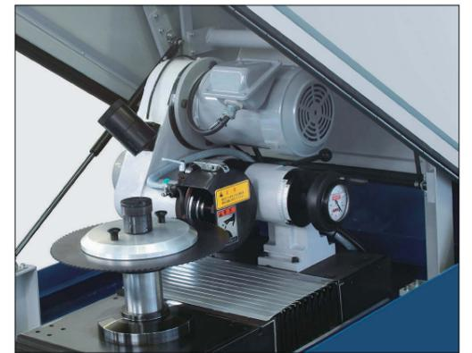
▶ 高圧クーラントシステムを、カバーインターロック付防塵カバーが保護し、切削液はマグネットシャフトで分離され、自動潤滑給油装置が標準装備されています。
