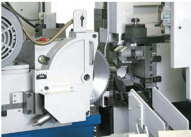
▲ 切断送り方式は、実績のある直動ベアリングスライド方式を採用しています。送り駆動は、油圧シリンダ送りが標準仕様です。オプションでサーボモータ・ボールねじ送りに変更可能です。鋸刃回転は、インバータによる無段変速でHSSソリッドソーから超硬チップソーまで柔軟に対応できます。（超硬チップソー仕様は、オプション）
