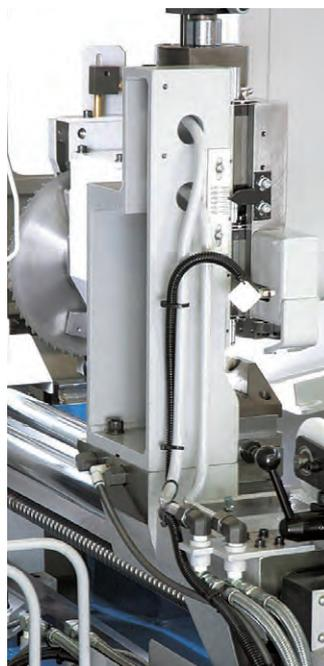
◀ 素材送り込み装置は、サーボモータ・ボールねじ駆動を採用し、高速かつ高精度な定寸送りが可能です。GFCバイスは、縦バイス構造となっており、フローティング機構（標準装備）を採用することで材料送り込み時のスリキズを防止します。
