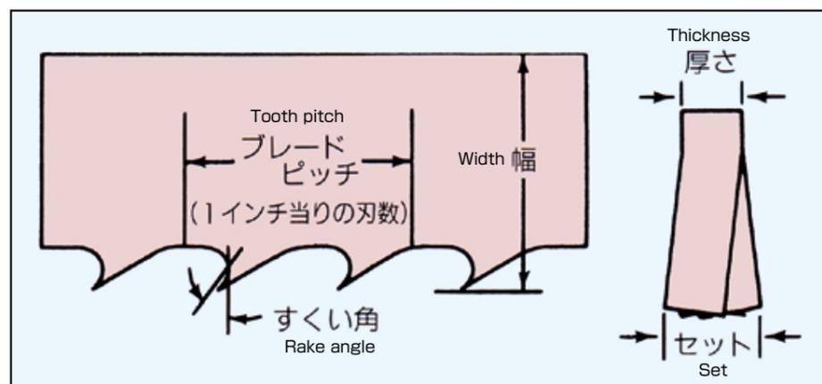
厚さ：ブレードの胴部の厚さで、厚くなれば鋸刃の剛性が大きくなります。
