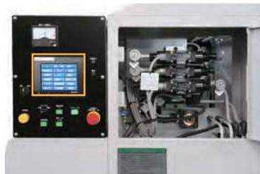
操作盤と同一面に配置された油圧バルブ、津根独自のユーザインターフェイスにより、快適で円滑な操作を提供します。
