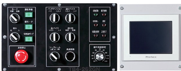
▲本機の操作パネルとNC入力のタッチパネルです。NC装置に入力されたプログラムと作業中のプログラムの内容は同時にタッチパネル上に表示されます。
